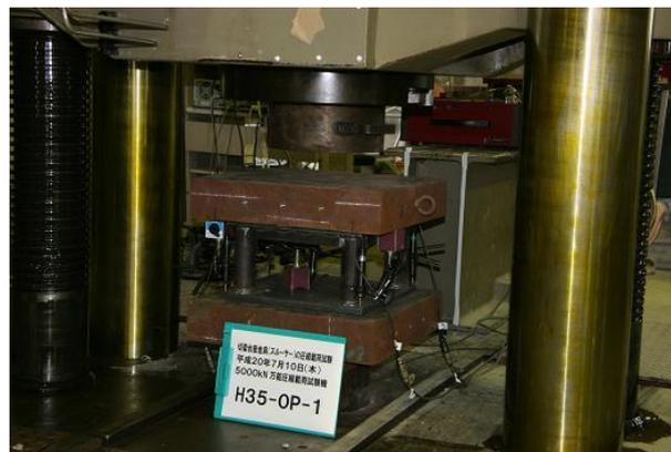
写真 3 一軸圧縮試験概観
