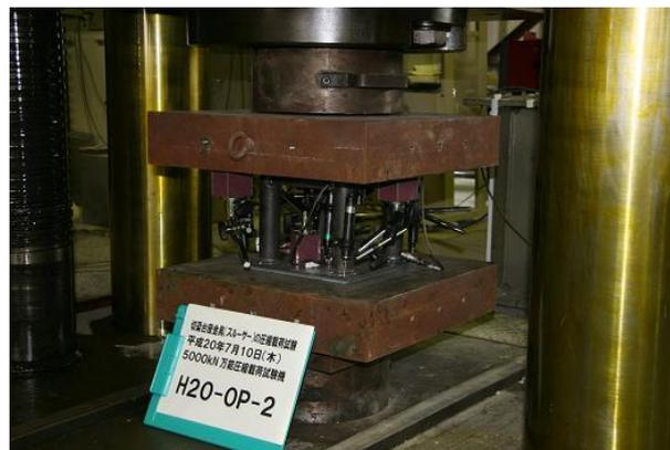
写真1 一軸圧縮試験概観
