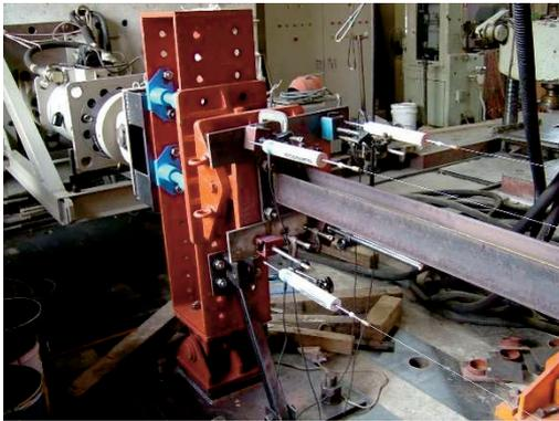
写真 1 軸力載荷装置
