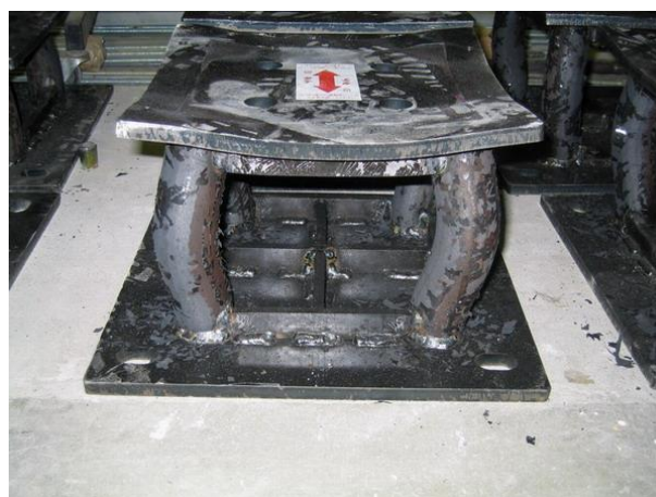
写真2 試験後のスルーサーA
